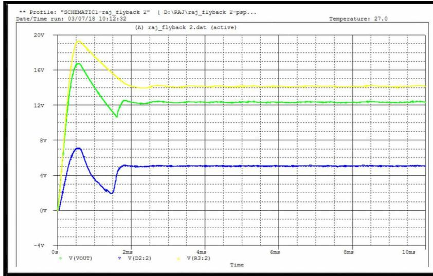
**FIGURE4** OUTPUT WAVEFORM OF CLOSED LOOP FLYBACK CONVERTER
