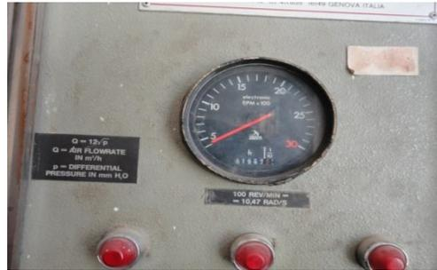
**Fig (3),** Tachometer type (VDO)
