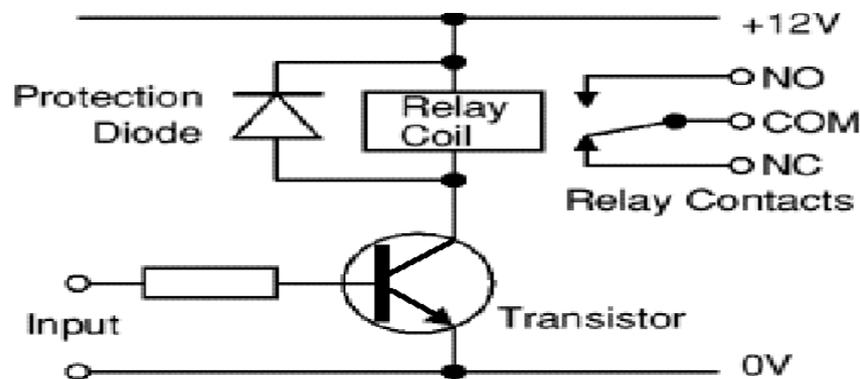
Fig.3 : Relay Circuit
